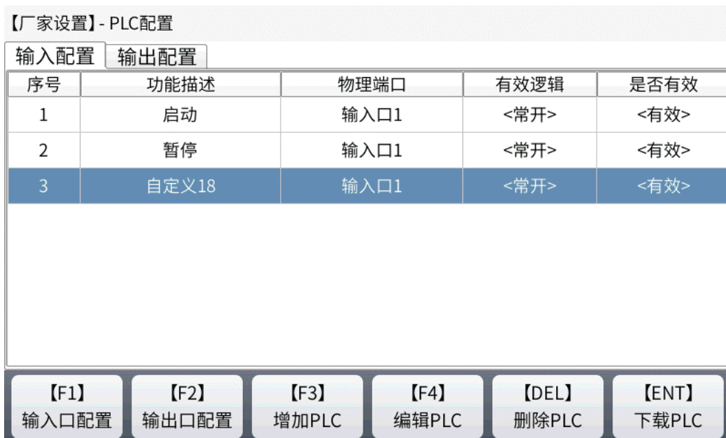
图 7.3.1 厂家设置-PLC 配置-输入口配置界面
