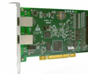
i6系列PC\_Based式EtherCAT总线运动控制器，能帮助机器控制软件的开发人员在原有高级语言开发环境下的快速继承，便于数控自动化设备在多轴、多I/O应用方向的拓展，特别适合原运动控制轴卡为上位方案的技术升级。
